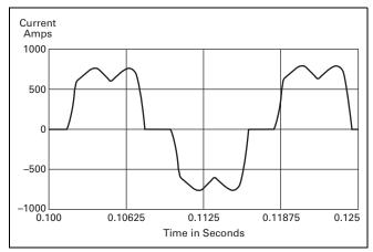
Figure 31.0-7. 100 hp Six-Diode Rectifier Design
